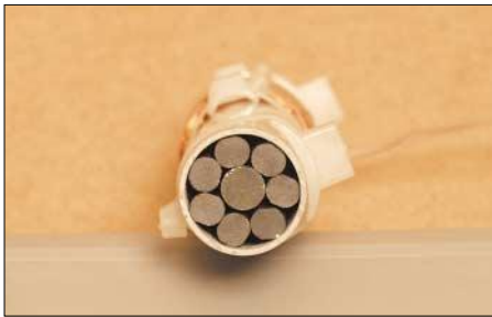
Bild 12: Querschnitt eines zusammengesetzten Ferritstabes; das Kunststoff-Stützrohr gibt den einzelnen Kernen Halt.
