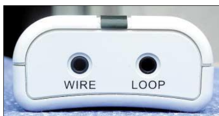
Bild 4: Auf der Rückseite befinden sich die Buchsen für den Anschluss von Draht- und Loopantenne.
