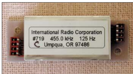
Bild 3: Inrad-CW-Filter; f_m = 455 kHz, B = 125 Hz, S = 2,2 Fotos: DJ2EV
