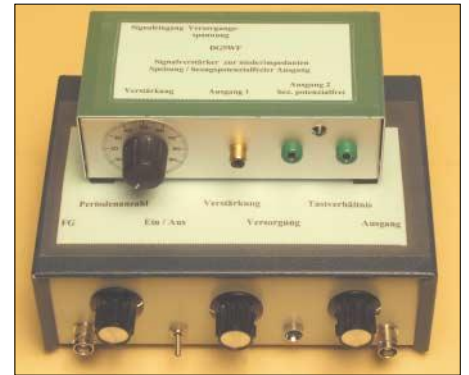
Bild 25: Zwei kleine Hilfsgeräte, die das Experimentieren mit den Ferritantennen enorm erleichtern. [12] beinhaltet eine genaue Beschreibung des PZGs (unten), mit dem die notwendige Spulenbedämpfung zur unverfälschten Übertragung festgestellt werden kann. Fotos und Screenshots: DG9WF
