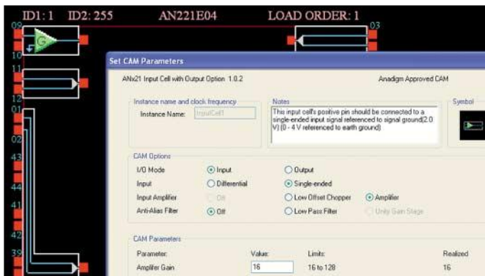
Bild 10: Die Eingangszellen des FPAA können in den unsymmetrischen Modus geschaltet werden.
