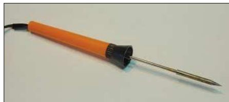
Bild 15: Zum Verlöten von SMD-Bauteilen sind Lötadeln aufgrund ihrer mechanischen und thermischen Eigenschaften weniger geeignet.
