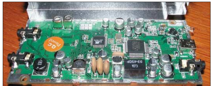
Bild 2: Das Plastikgehäuse lässt Schlimmes vermuten, doch der Empfänger ist abgeschirmt untergebracht.
