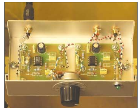
Bild 20: Innenansicht des Antennenverstärkers. Durch die Aufteilung der unterschiedlichen Verstärkungsfaktoren (5- und 30fach) kann die Antenne sowohl für schwache Signale eingestellt werden, sie lässt sich aber auch für den Empfang der hohen Amplituden von Blitzzferics verwenden.
