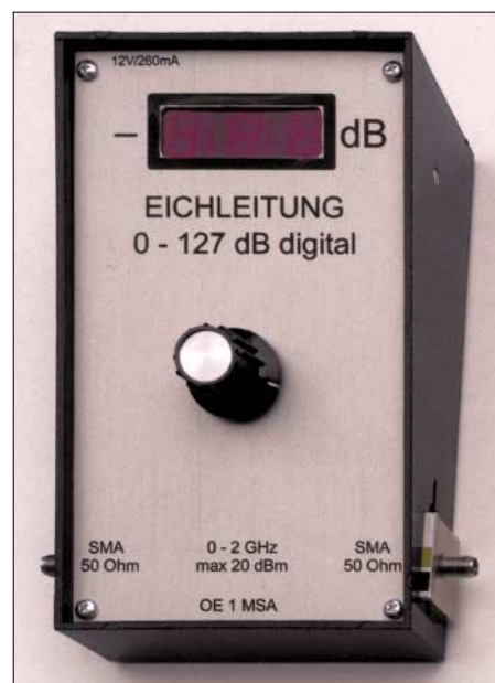
Bild 1: Die kommerziell hergestellte Dämpfungselemente wird mit der Steuerung in einem Pultgehäuse untergebracht. Sie lässt sich so ohne Schalt- und Rechenfehler bedienen.
