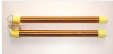
Bild 24: Bei diesen beiden VLF-Antennen wurden die Wicklungen auf ein Kunststoffrohr aufgebracht, in dem sich vier 5 cm lange, angereicherte Ferritstäbe mit 1,25 cm Durchmesser befinden.
