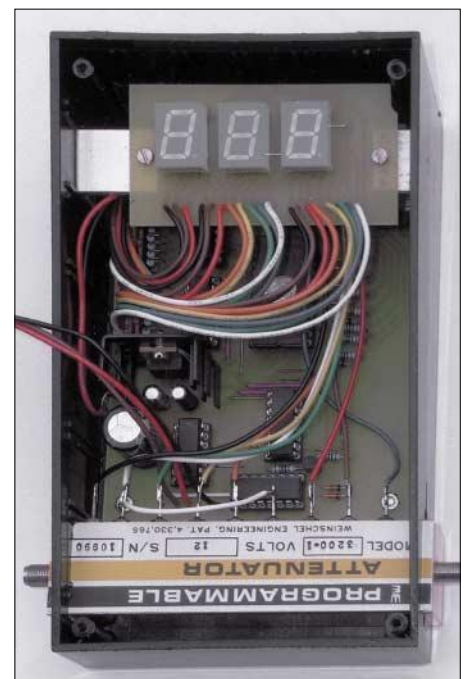
Bild 4: Über kurze Drähte bzw. Kabel wird die Hauptplatine mit der Anzeige und der Dämpfungseitung verbunden. Teile des Abschwächers und die beiden SMA-Buchsen ragen aus dem Gehäuse heraus. Fotos: OE1MSA
