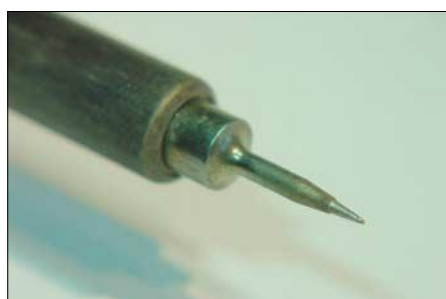
Bild 16: Leistungsstärkere Lötkolben mit einer dünnen Spitze eignen sich gut für SMD-Lötarbeiten. Fotos: DG4RBF
