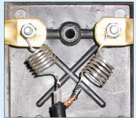
Bild 12: Kompensationsspulen und Transformationsleitung RG62 im Dipolanschlusskasten; für den 82 cm langen Faltdipol ergaben sich zwei Teilspulen à 6 Wdg., l = 14 mm, D = 12 mm, aus 1,0 CuAg. Foto: DL2RD
